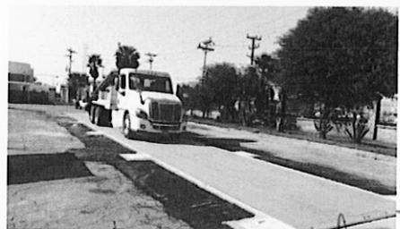
**BASCULA AK BASCULAS 100% DE ACERO SIN RIEL GUIA INSTALADA SOBRE EL PISO Y FOSA**
