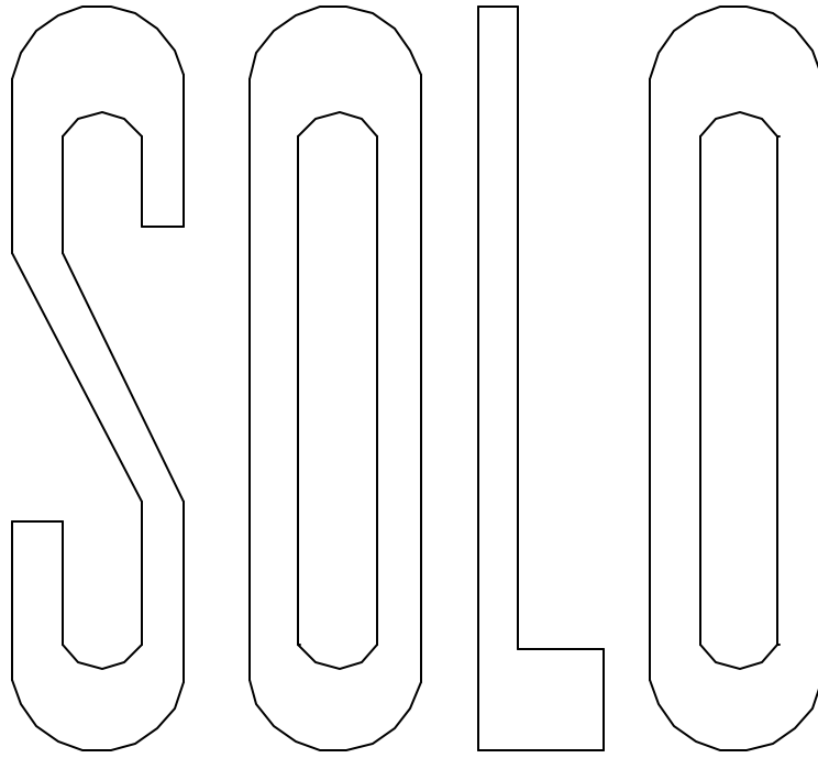
Figura 6.10 La palabra “SOLO” se marcará en el carril exclusivo para dar vuelta izquierda y adelante, a 40 m en el mismo carril se complementará con una flecha hacia la izquierda.
