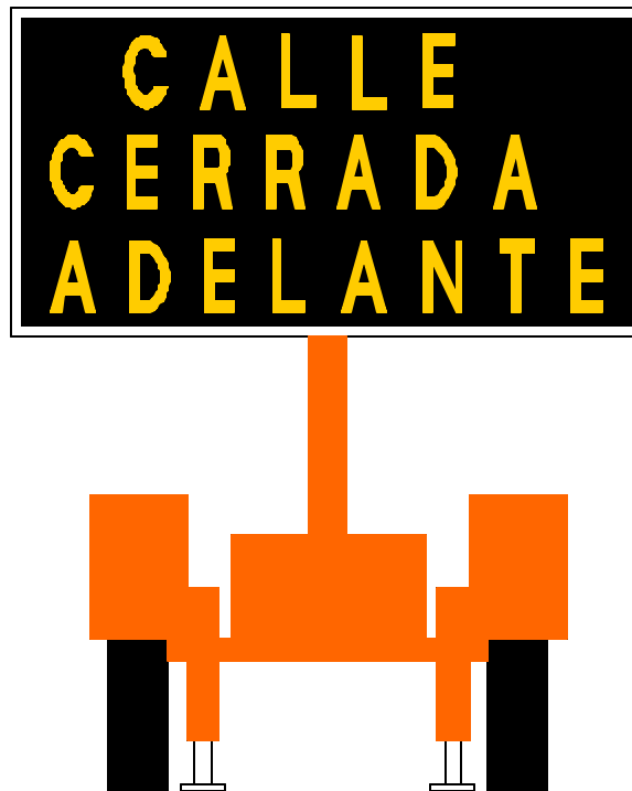
Figuras 8.9 Señalamiento portátil con mensaje variable.
