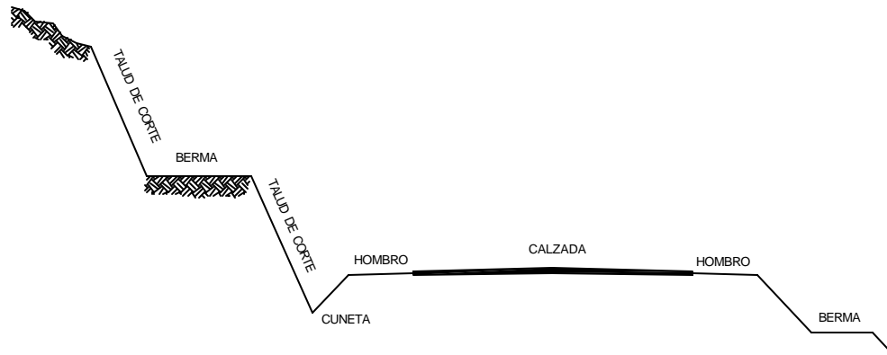
Figura 10.15 Bermas en cortes y terraplenes.
