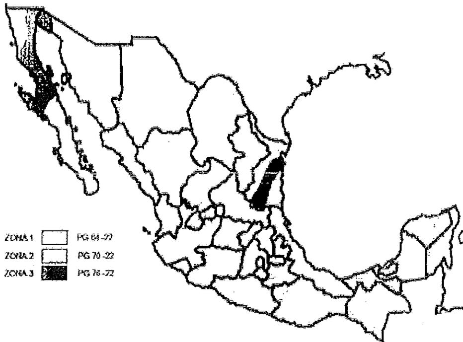
Figura J-8 Regiones geográficas para la utilización recomendable de cementos asfálticos Grado PG (Fuente S.C.T)
